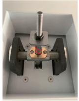
(图一为打开顶盖状态,把中轴向上拉出,沿图二红色箭头指示位置滴润滑油)
