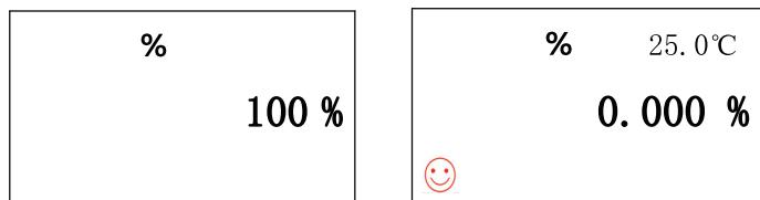
注：若基数物品使用称量纸或容器，则实际测试物品百分比时应使用同样的称量纸或容器，否则将会产生测试误差。
