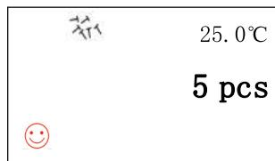
注：若计数校准时使用称量纸或容器，则实际计数操作时应使用同样的称量纸或容器，否则将会产生计数误差。
